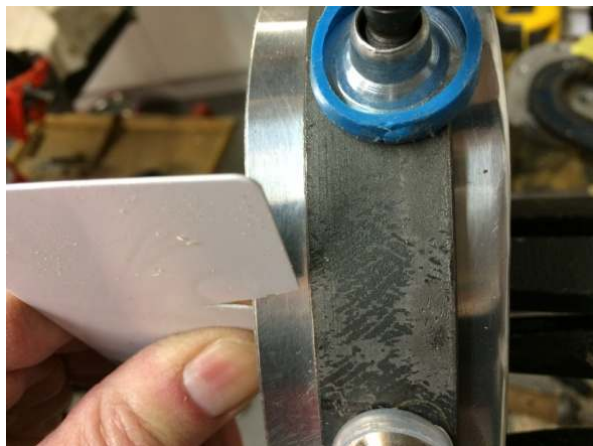
Steel edge set back 1.2mm.
